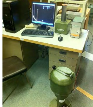
Мультирад МКС Для измерения активности и удельной активности альфа-, бета- и гамма-излучающих нуклидов
