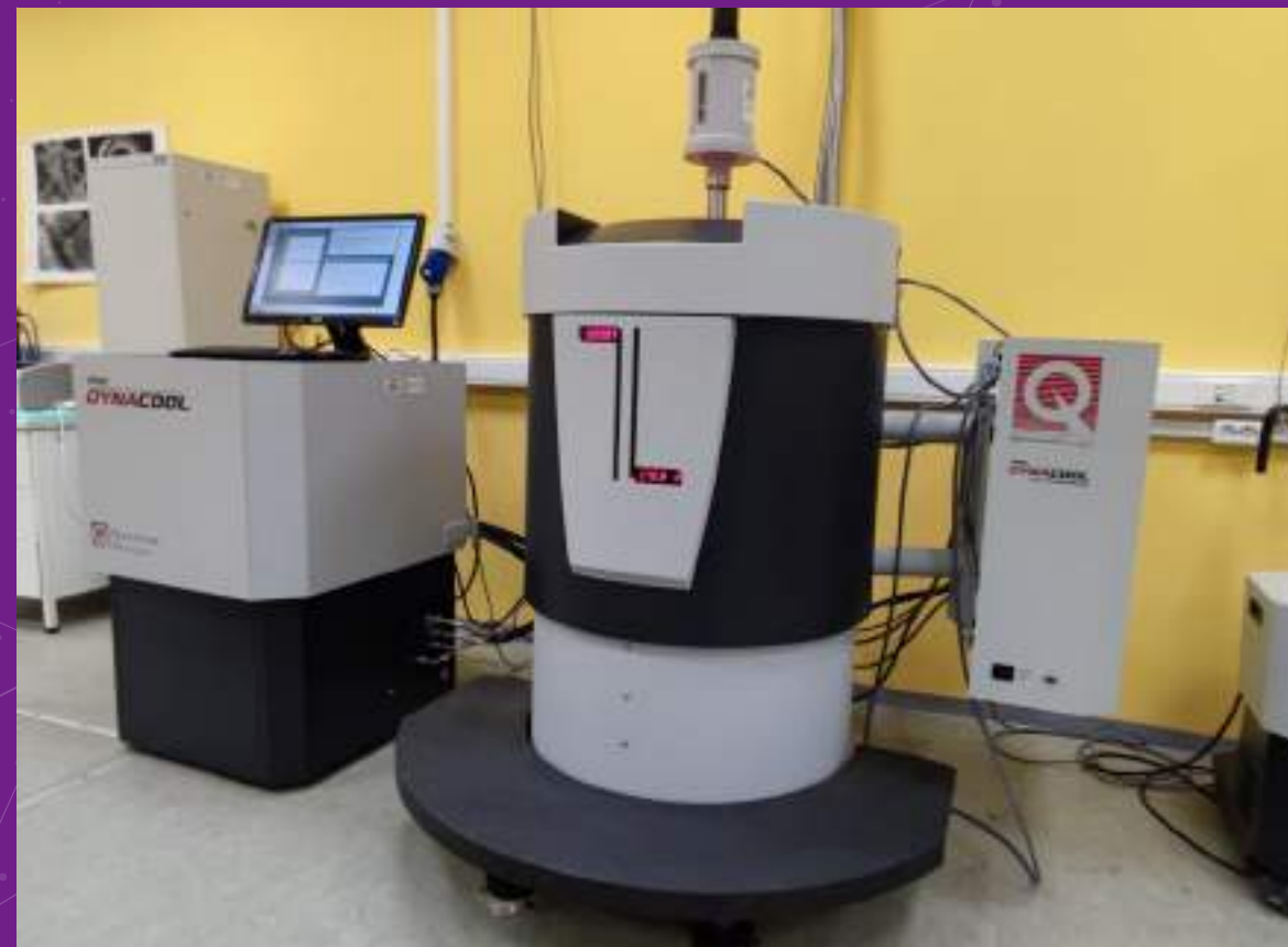
Общий вид измерительной части PPMS ® DynaCool ™ в лаборатории ЦКП им. Д.И. Менделеева
