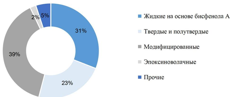
**Рисунок 3 - Виды эпоксидных смол и их доля в структуре производства, %<sup>7</sup>**
