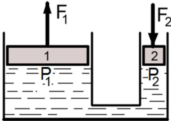
Рис.2.3. Схема гидравлического пресса
