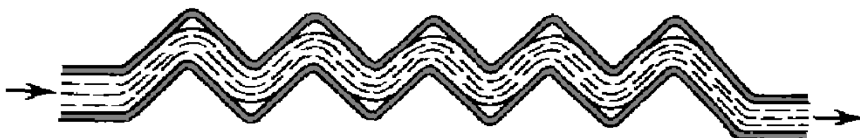
Рис. 40. Характер движения потока жидкости в канале, образованном двумя соседними гофрированными пластинами
